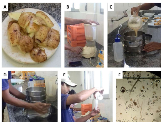
Figura 5. Procedimento de preparo das amostras (A), trituração (B) e separação com jogo de peneiras (C e D) de ovos e nematoides. Material coletado (E) e observado em microscópio de luz (F) [Sample preparation procedure (A), crushing (B), and separation with set of sieves (C and D) of eggs and nematodes. Collected material (E) and monitored under light microscope (F)]. Morrinhos, Goiás State (GO), Brazil, IF Goiano, Morrinhos Campus, 2017.
